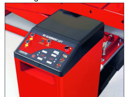
Oddzielna konsola montowana z lewej lub prawej strony, ustawiana w odległości do 4,5m od dźwignika.
