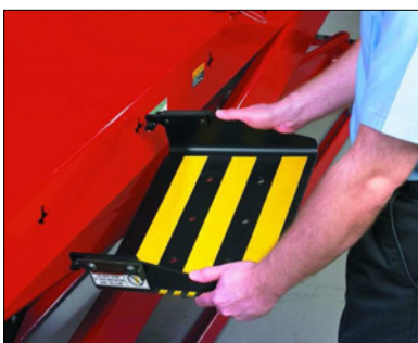
Dwa lekkie, aluminiowe schodki ułatwiające pracę diagnosty.
