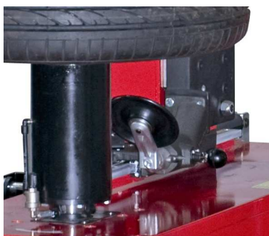
Dolna rolka ułatwiająca demontaż opony z felgi.
