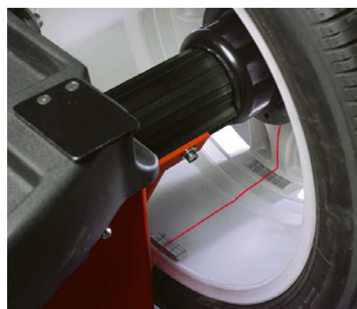
System HAMMERHEAD wyposażony jest w oświetlenie wyważanego koła oraz laser wskazujący dokładne miejsce mocowania (naklejania lub nabicia) ciężarka. Obie te funkcje przyspieszają proces wyważania.
