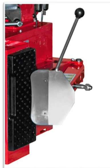
zbijak o dużej sile i prędkości sterowany pedałem
