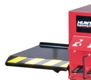
Dźwignik (opcjonalnie) unoszący koło na wysokość stołu montażowego (udźwig do 100kg).
