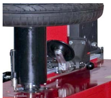
Dolna rolka ułatwiająca demontaż opony z felgi.
