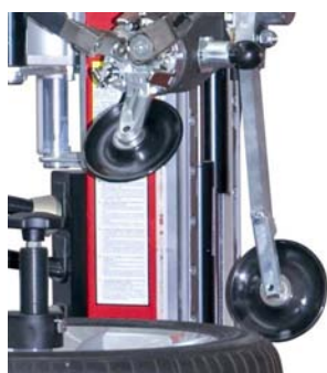
Górne rolki dociskowe ułatwiające montaż i demontaż opon niskoprofilowych i RunFlat.
