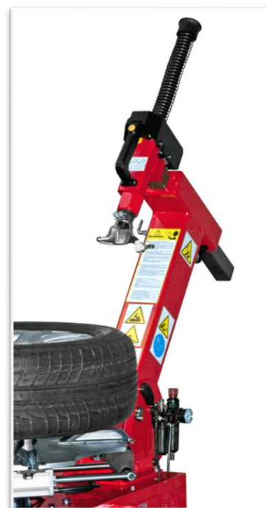
kolumna odsuwana do tyłu sterowana pneumatycznie
