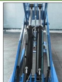
Podwójne siłowniki wraz z zintegrowaną blokadą mechaniczną
