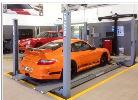
Dźwignik 4-kolumnowy SM40 w wersji zagłębianej
